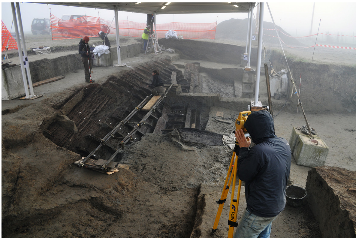
Figura 11. Rilevamento con stazione totale e laser scanner del relitto di imbarcazione di V secolo di Santa Maria in Padovetere (Comacchio) (foto: C. Beltrame)
