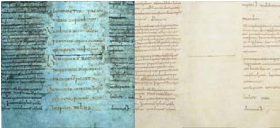
Figura 7. Fluorescenza UV (sinistra) e di Immagini RGB (destra) della pagina 66. L'immagine della fluorescenza UV opportunamente elaborata mostra chiaramente come sia stato possibile rendere leggibile il testo scritto con inchiostro rosso parzialmente perso se osservato in luce visibile
