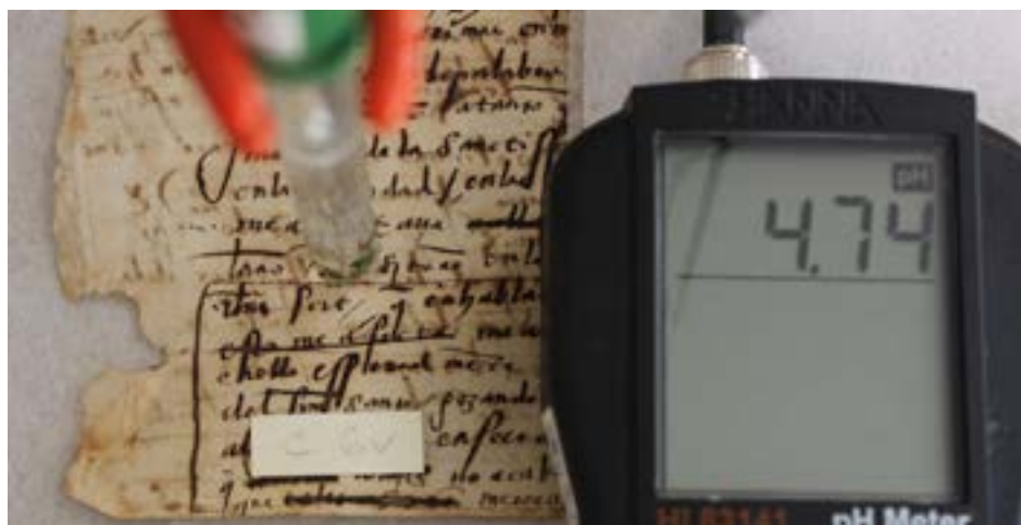
Figura 9. Foglio 6, rilevamento del pH superficiale delle carte dopo la rimozione del velo di seta
