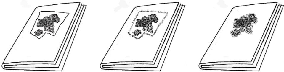
Figura 3 Tecniche di riparazione di lacune. Il materiale usato per coprire la lacuna si estende oltre i margini della mancanza (1), si estende oltre ed è sbrizzato nei contorni (2), copre soltanto la lacuna (3)
