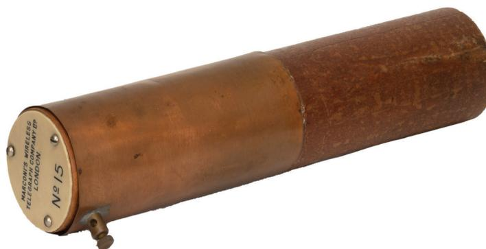
Riproduzione di condensatore variabile 'Billi condenser' (n. 15)
