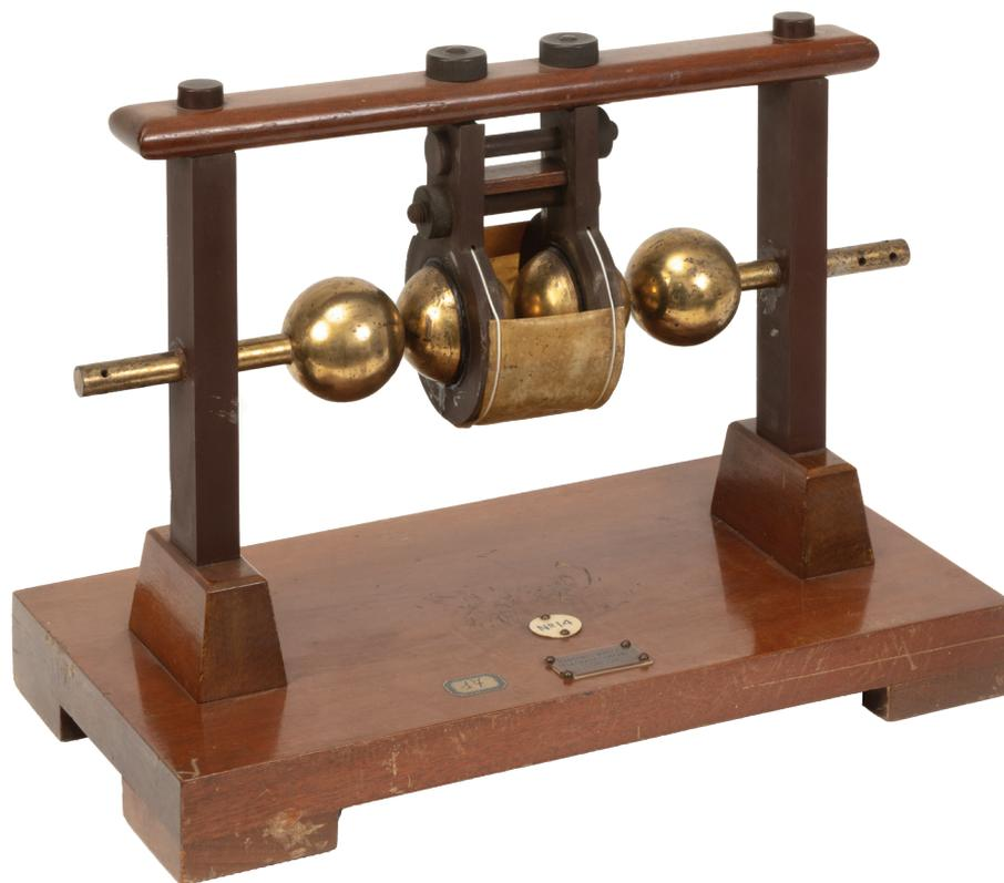
Riproduzione di un 'oscillatore di Righi', o spinterometro a quattro sfere, Marconi's Wireless Telegraph Company Ltd., 1932, inv. D-000030
