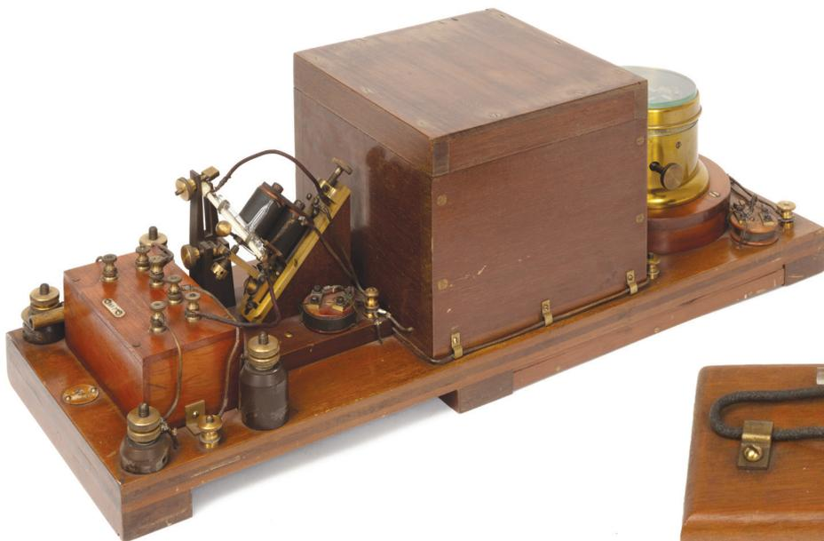
Riproduzione di ricevitore a *coherer* per telegrafia senza fili (n. 7)
