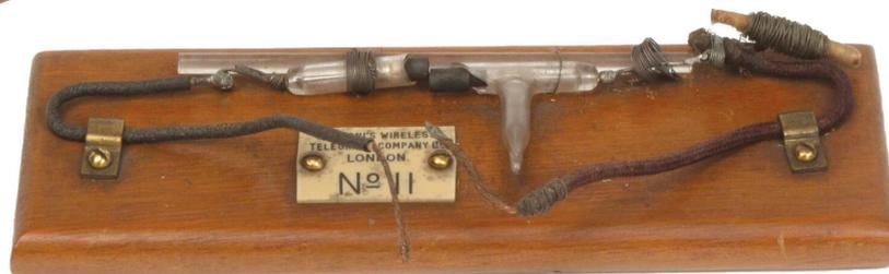
Tubetto rivelatore di onde elettromagnetiche *coherer* (n. 11)
