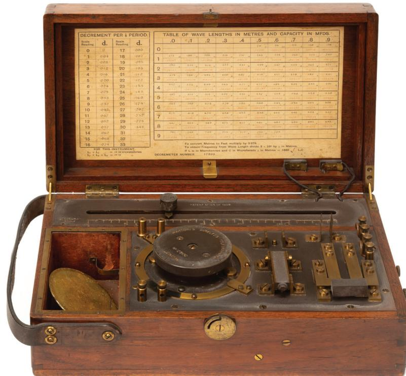
Ondametro 'The Marconi Direct Reading Portable Decrementer' (decrimetro portatile a lettura diretta)
