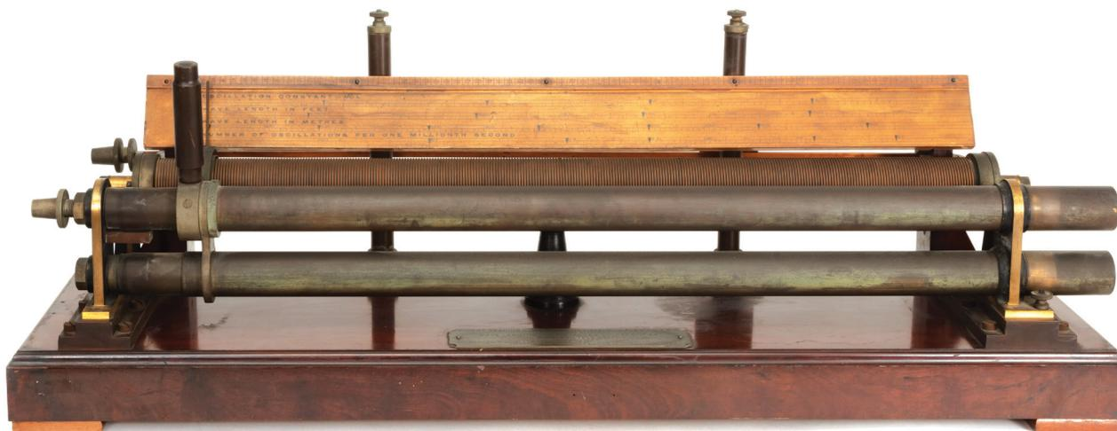
Ondametro 'Direct Reading Cymometer' (cimometro a lettura diretta)
