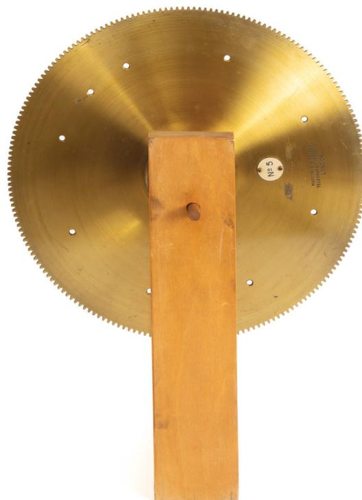
Spinterometro a disco rotante per stazione radiotelegrafica da 5 kW (n. 4), con disco dentato di ottone (n. 5)
