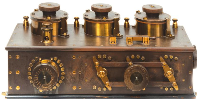
Ricevitore radiotelegrafico di tipo commerciale, detector Magnetico Marconi (n. 13)
