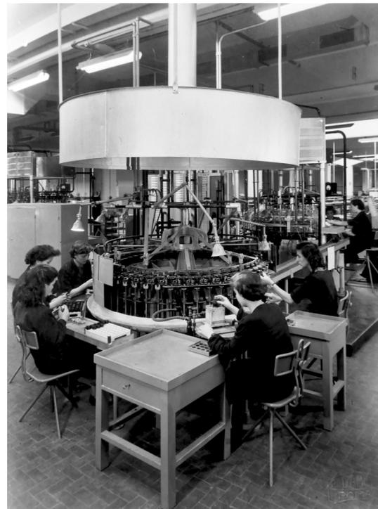
**Figure 3-4** Operatrici al lavoro nell'impianto per la fabbricazione di valvole dell'Aquila, OBL mss photograph c258-9
