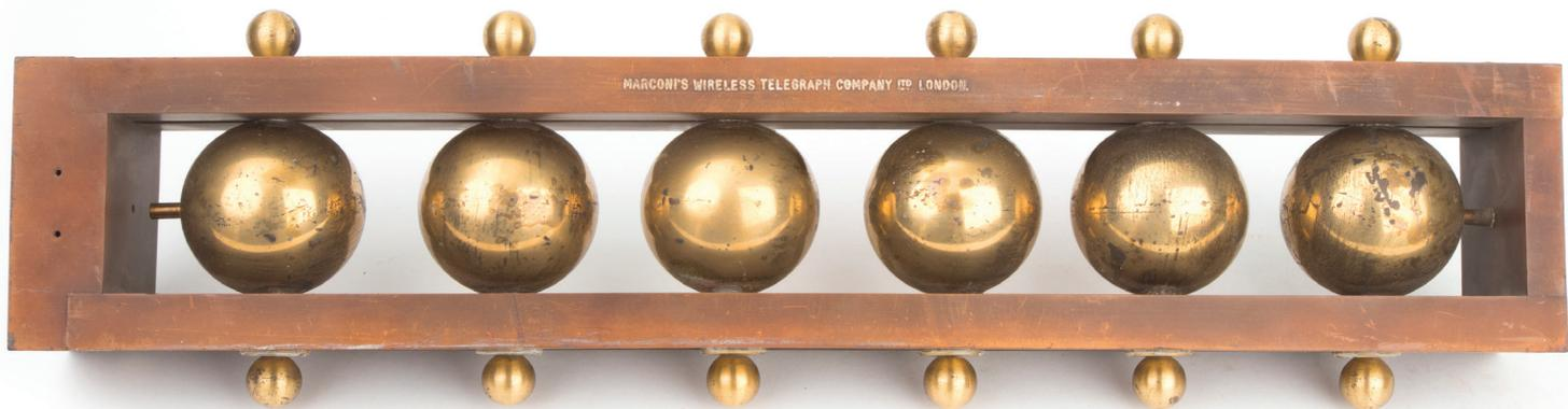
Riproduzione di oscillatore (o spinterometro) a sfere multiple (ex n. 6?)
