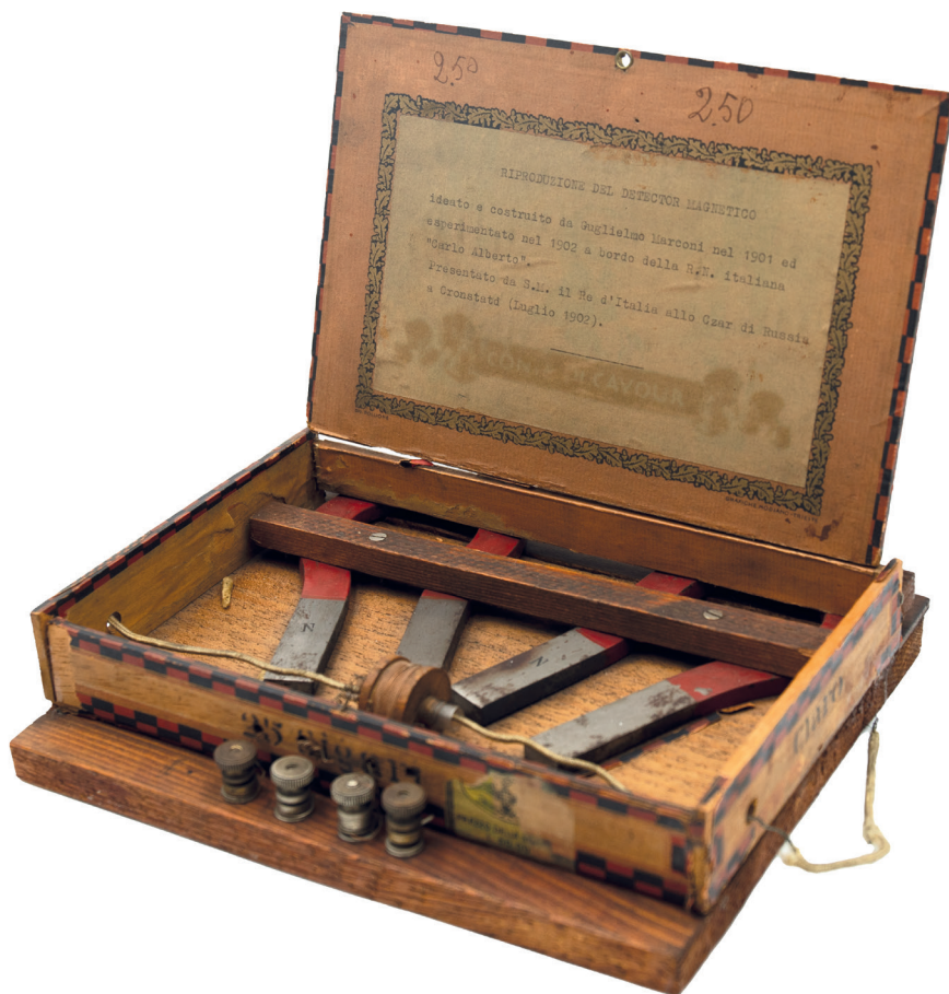
Riproduzione di detector magnetico in scatola di sigari. Anni Trenta del Novecento. Inv. IGB-2139
