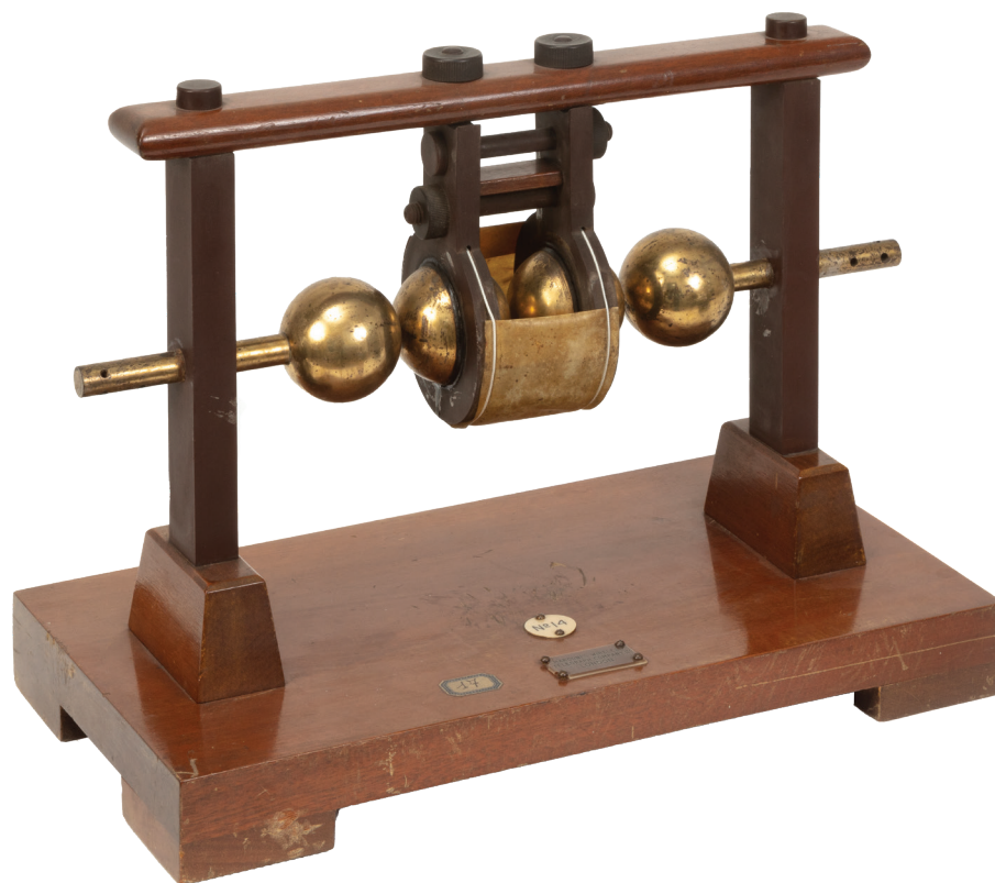
Riproduzione di un 'oscillatore di Righi', o spinterometro a quattro sfere, Marconi's Wireless Telegraph Company Ltd., 1932, inv. D-000030
