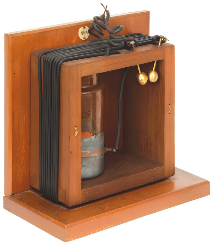
Riproduzione di circuito sintonico trasmittente sperimentale secondo il brevetto n. 7777, attribuito a Marconi's Wireless Telegraph Company Ltd., 1932. Inv. IGB 002137
