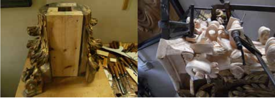
Figura 8. Integrazione e intaglio di un capitello
